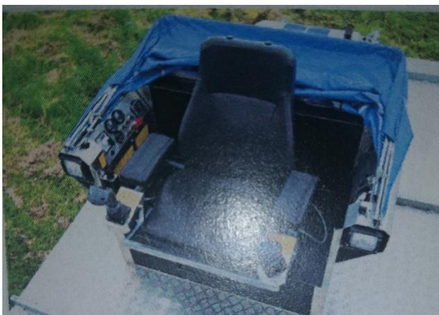
Ergonomischer Fahrersitz mit Joysticks zur Steuerung der Maschine und zum Bedienen der jeweiligen Werkzeuge.
